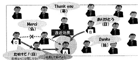
図4 提案方式がベースとするCDMA+マルチホップ通信の原理
