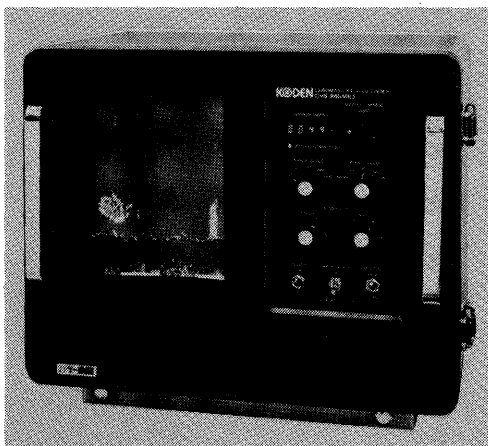
写真2 DRAMを使った最初のカラー魚探、CVS-885型11型ブラウン管表示機
