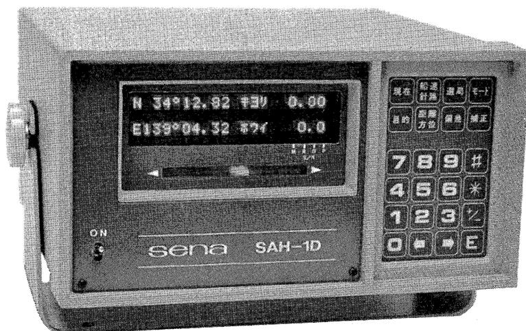
最新の電子技術を結集した完全自動化のデッカ受信機でデッカのレーン，または緯・経度のいずれでも表示でき，さらに航海計算等の種々の機能を内蔵しており，様々な航海情報を得ることができます。
