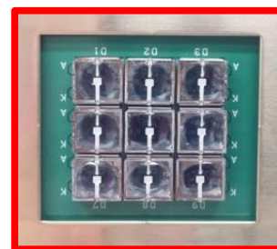
受光素子: PD (LEC-RP0508) 感度 0.2A/W 受光光学系: 口径28cm望遠鏡
