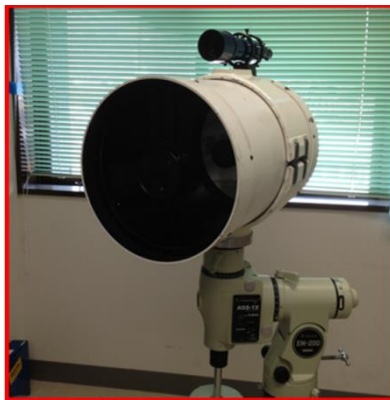
受光素子: PD (LEC-RP0508) 感度 0.2A/W 受光光学系: 口径28cm望遠鏡
