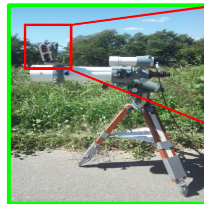
送信側: LED (NVS119A) 最大出力 2.7W/LED 凹面鏡、半値角 3deg.
