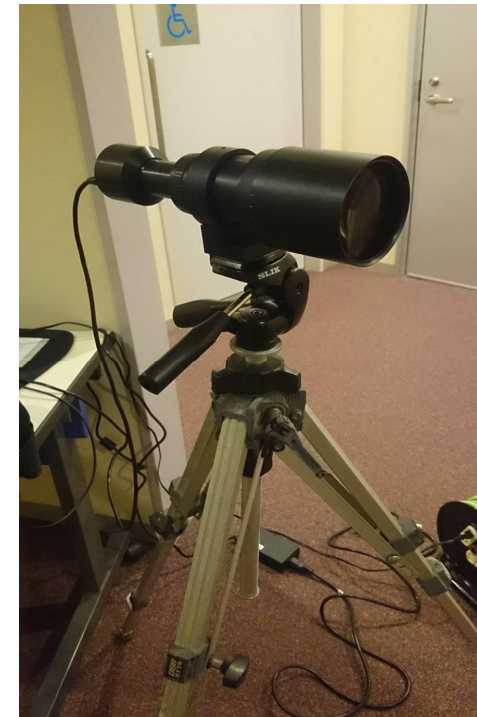
光電子増倍管(PMT)H7826 浜松ホトニクス Φ19mm
